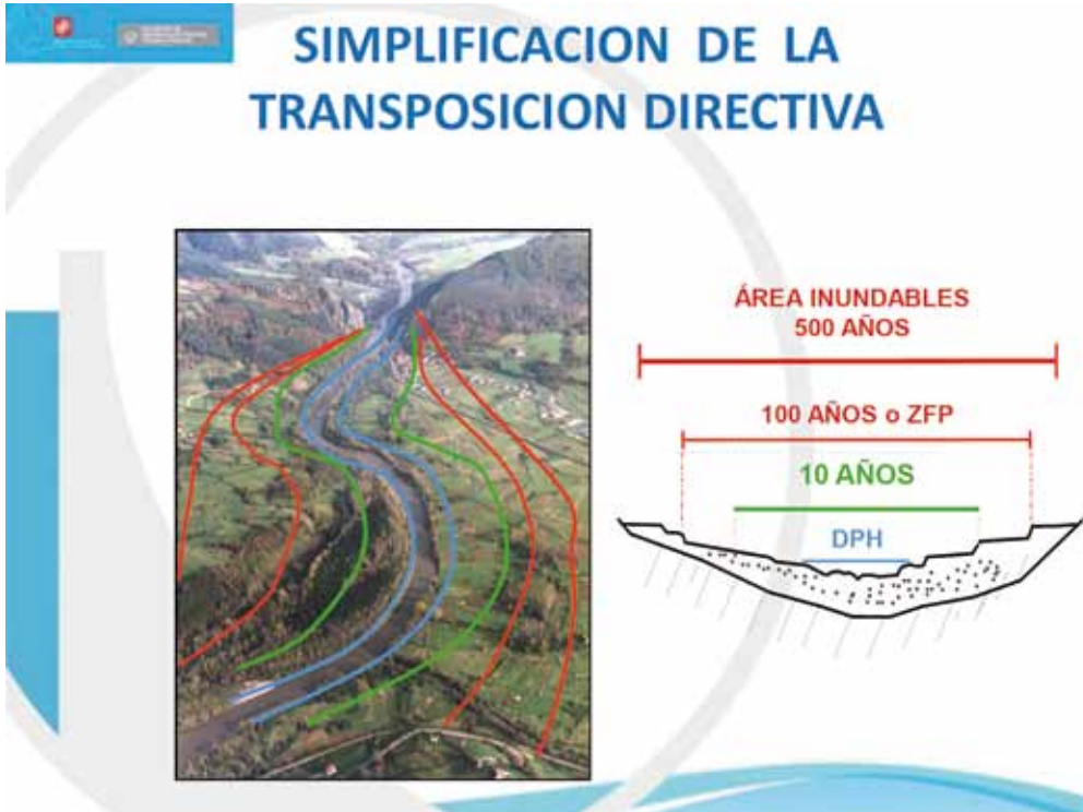
Fig. 5. Alternativas para la simplificación de la zonificación de las áreas inundables
