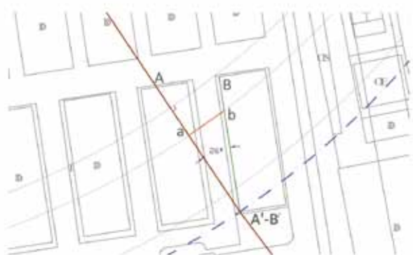
Fig. 7. Proyección del perfil de asientos transversal al túnel (sección A-A') en el plano de la fachada (sección B-B')
