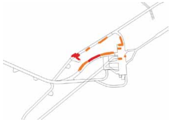
Fig. 30. Registro de estallidos en el complejo de Casa de Máquinas
