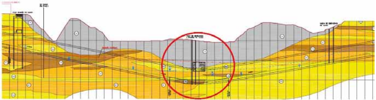
Fig. 3. Perfil longitudinal geotécnico
