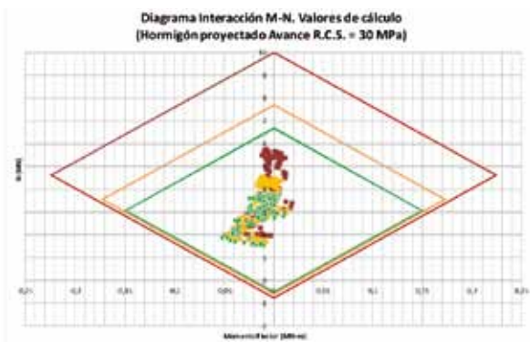
Fig. 3. Aplicación de las fórmulas propuestas a la comprobación de esfuerzos
