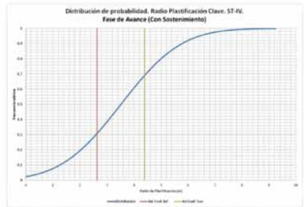
Fig. 31. Caso práctico: distribución estadística resultante para el radio de plastificación final. Estimación de longitud de bulones
