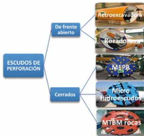
Gráfico 1. Esquema de escudos de perforación
