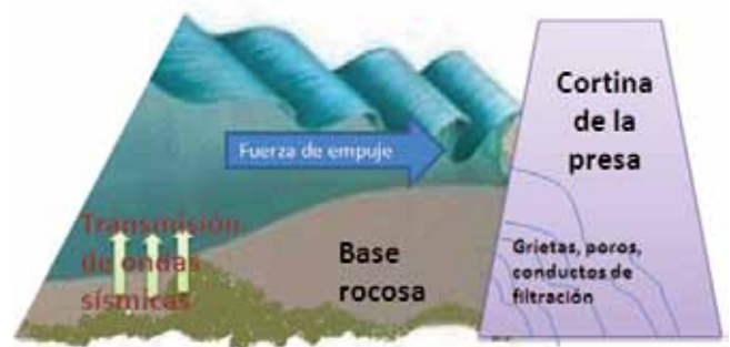
Fig. 5. Fallas por pérdidas generadas por el incremento de la filtración en la base de cortina debido a la disminución de la compactación de los materiales y/o incremento de la porosidad, ocasionando la tubificación
