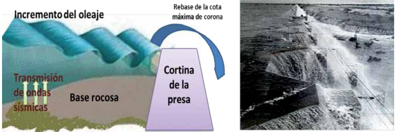
Fig. 8. Esquema de falla por rotura o colapso rebase debido al oleaje en la cortina (izquierda). Represa Rincón del Bonete sobre el río negro en Uruguay, durante la crecida de abril de 1959. Aunque no es el caso específico, se puede observar cómo el agua desborda la cortina (derecha)
