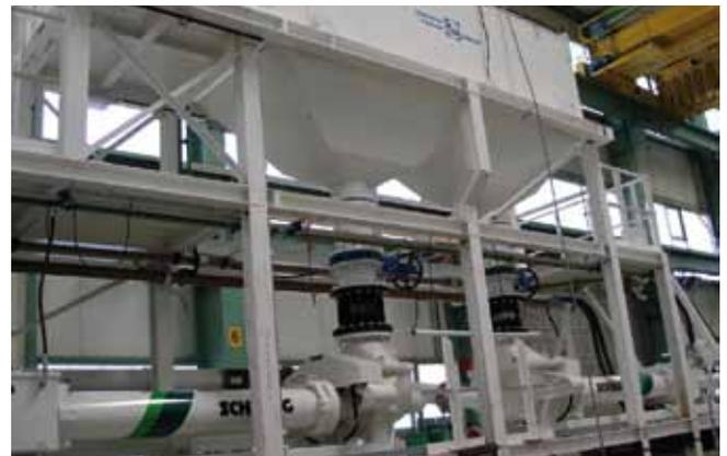
**Fig. 14. Sistema de bombeo de escombro desde la TBM a superficie**
