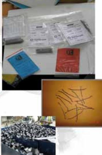
Fig. 7. Diversos tipos de fibras
