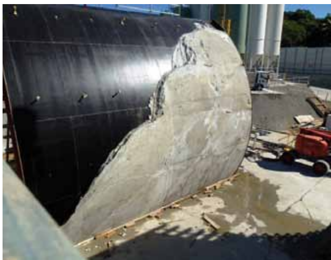
Fig. 16. Maqueta a escala natural del mortero bicomponente en Legacy Way
