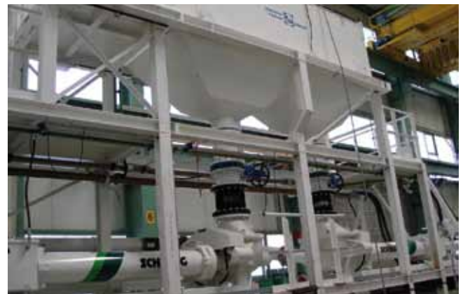
Fig. 14. Sistema de bombeo de escombros desde la TBM a superficie
