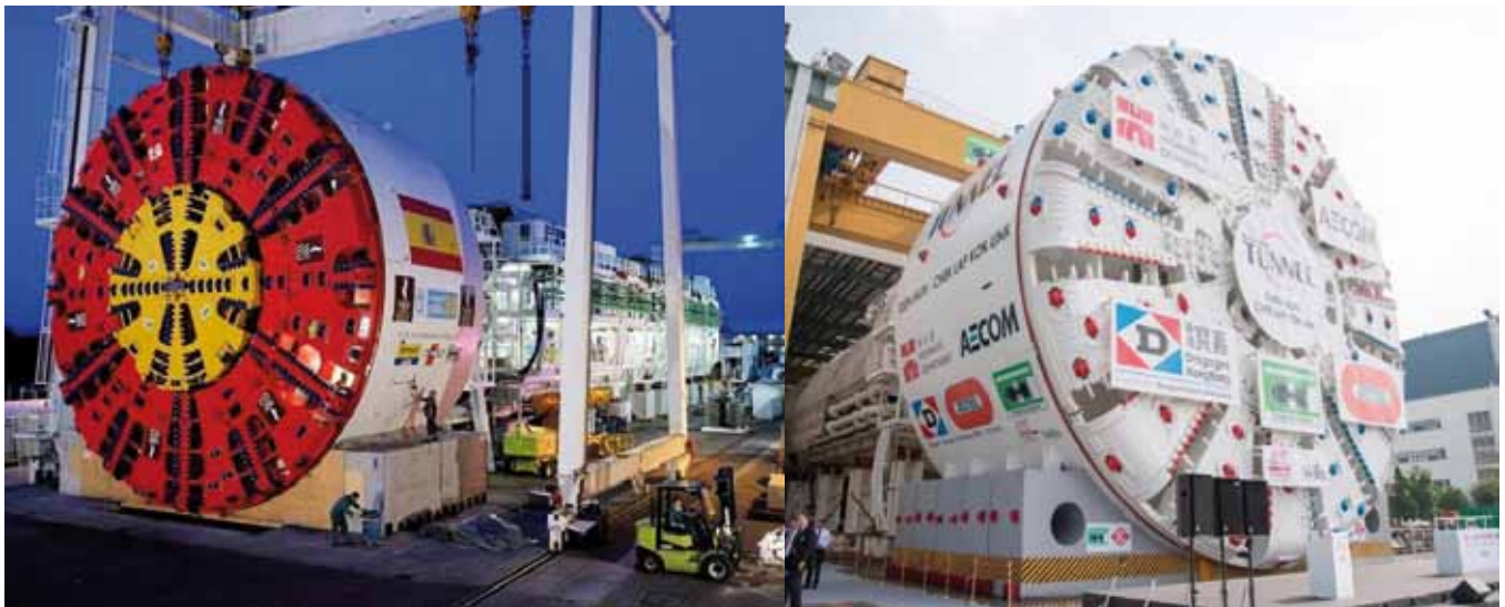
Fig. 12. Tuneladoras que alcanzaron record de tamaño, según su tipo, en el año de su fabricación
