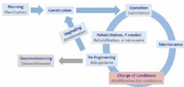
Fig. 16. Fases de la vida útil de una presa
