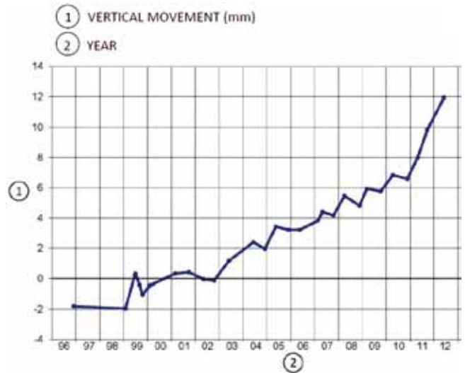
Fig. 12. Desplazamiento vertical del bloque del estribo derecho
