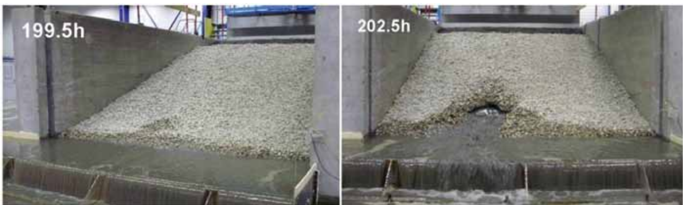
Fig. 8. Ensayo a gran escala de erosión interna
