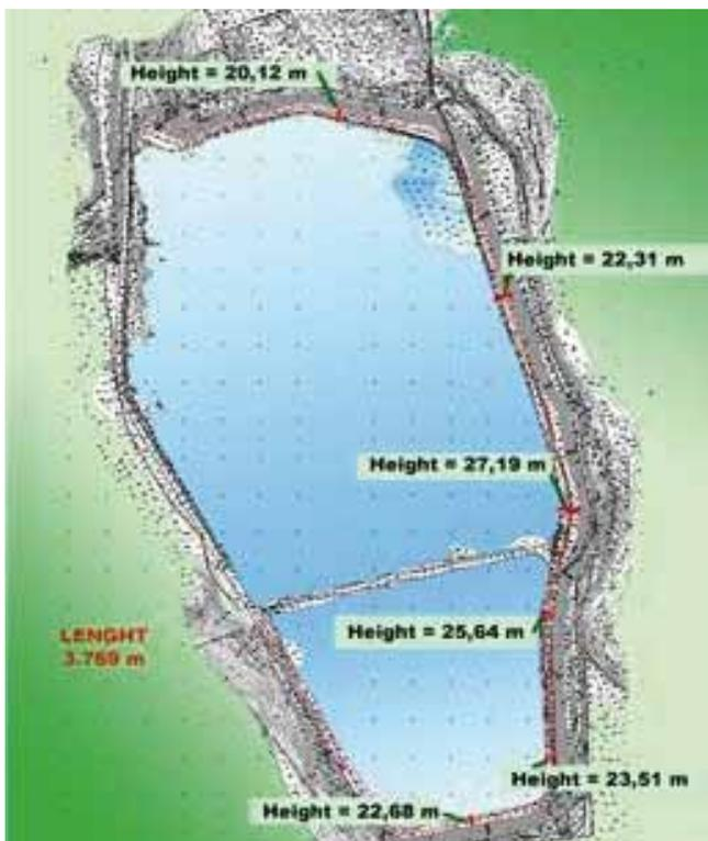
El proyecto consistía en una balsa de contención de residuos. La zona en la que la presa fue completamente destruida es en su zona más alta, de 27,19 m. Como se observa en la sección transversal (fig. 14) se colocó una pantalla en los aluviones para evitar la filtración, y un filtro que no llegaba hasta la coronación, ¿por falta de material de filtro?
