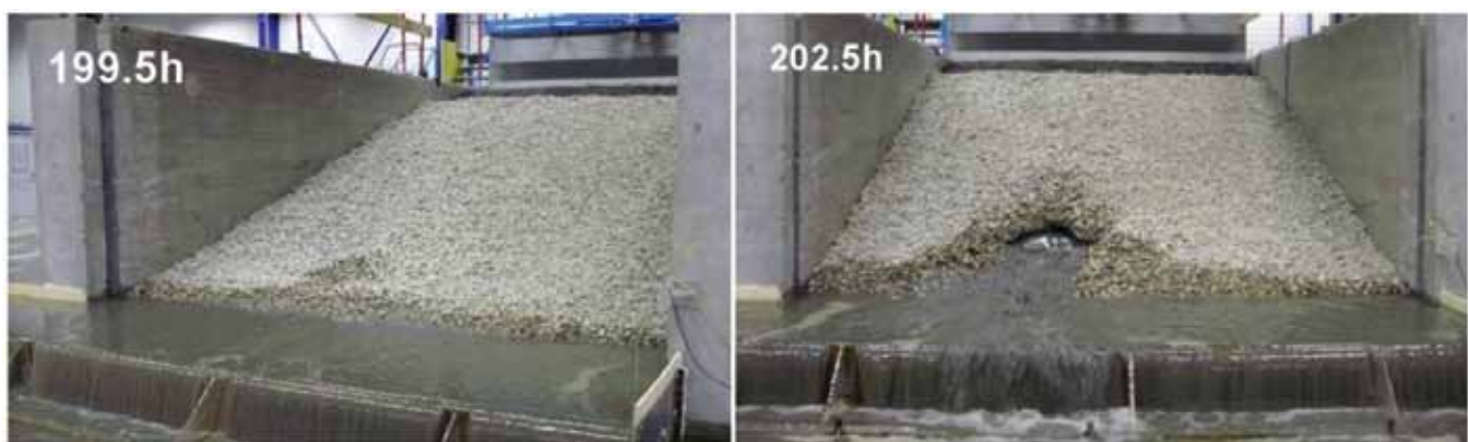
Fig. 8. Ensayo a gran escala de erosión interna
