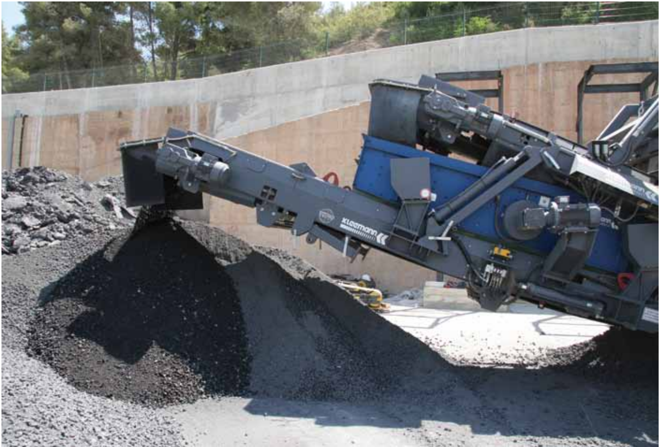
Fig. 8. Escorias negras saliendo de la trituradora
