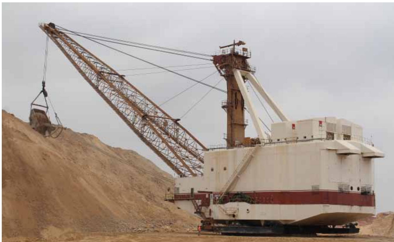
Máquina que opera en Khouribga y mueve 100 toneladas por palada
