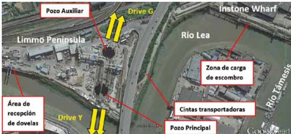
Fig. 4. Instalaciones principales en Limmo Peninsula
