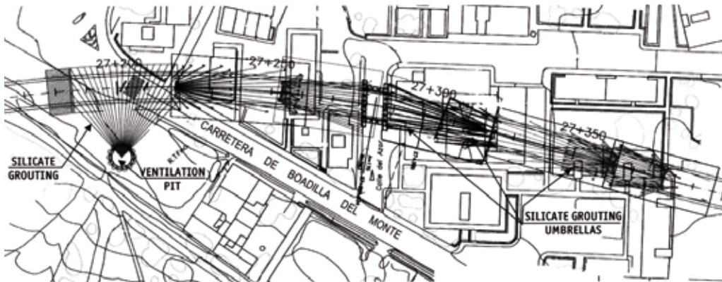
Fig. 11. Paraguas de inyecciones de silicatos (planta)
