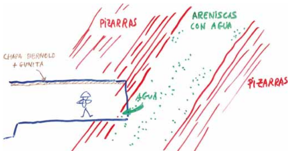
Fig. 8. Inestabilidad de frente (rotura y avance de medio metro). Túnel de Casimiro Sainz (Santander)
