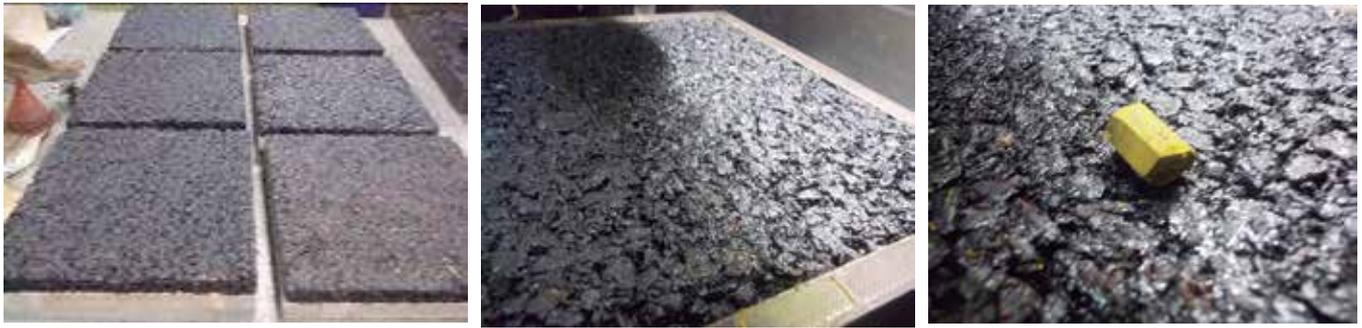
Fig. 4. Muestras de 30 x 30 de MAC F10 con asfaltos con NFU y SBS.
