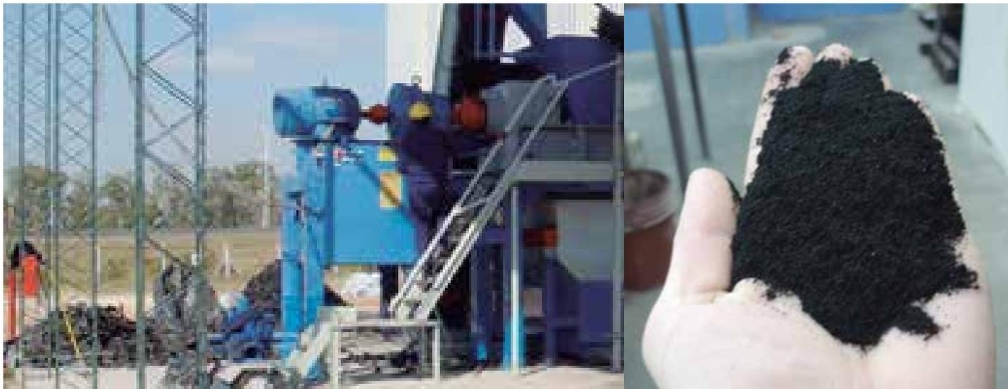
Fig. 2. Planta de trituración de NFU y polvo de NFU
