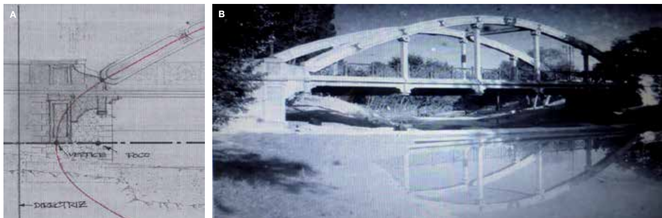
Fig. 21. A. La rama parabólica dibujada en roja, entra por el bulón de la articulación, pasa por la ménsula al estribo, y continúa rodeando el cauce; y B. Reflejo virtual del puente en la represa del Río, en la que los arcos dibujan la 'envolvente cabal' de su imagen modernista (dibujo del autor sobre plano primitivo y foto DPHu)
