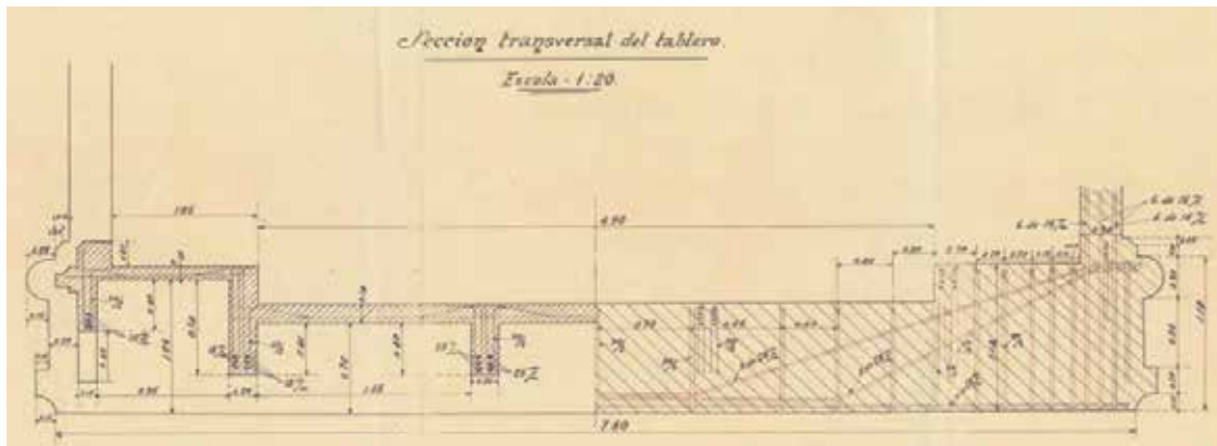
Fig. 20. Sección transversal por el tablero, y por la traviesa, a 1:20
