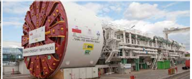
Tuneladora tipo hidroescudo. Gdansk. Polonia.
