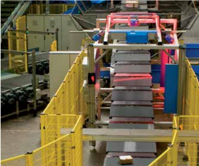
Clasificación de paquetería (cross belt)
