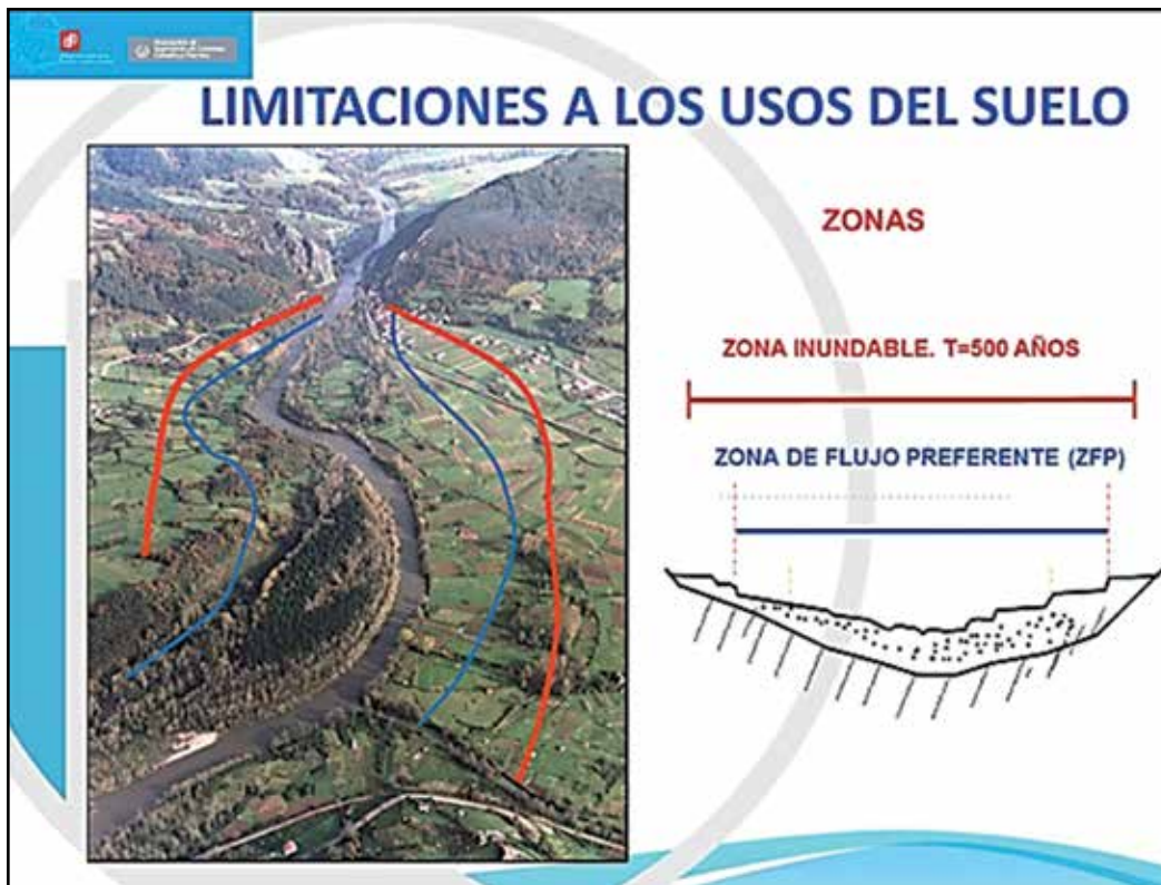
Fig. 9. Zonas en las que se limitan los usos del suelo. Zona de Flujo Preferente (ZFP) y zona inundable
