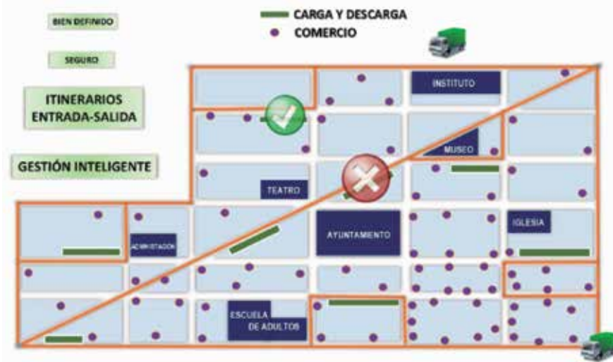
Fig. 13. Modelo de tráfico de mercancías con control horario y registro electrónico de rastreo de vehículos especiales
