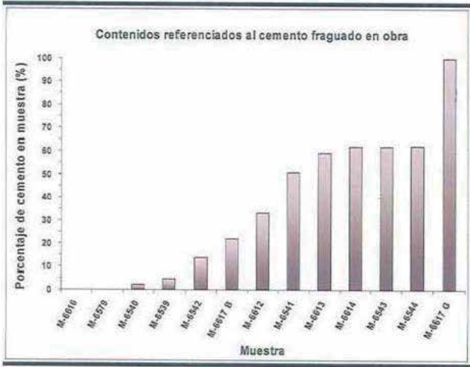
Figs.4.a y 4b: Control de Cantidad Cemento en suelo, según referencia patrón de laboratorio (b) u obra(a)
