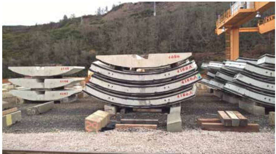
Fig. 10.b. Detalle dovela con doble junta de sellado
