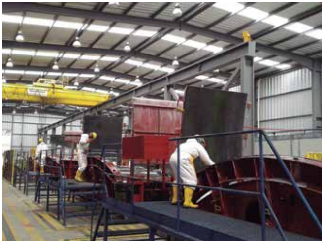
Fig.s 2 y 3. Vistas de las instalaciones de fabricación de los anillos de revestimiento
