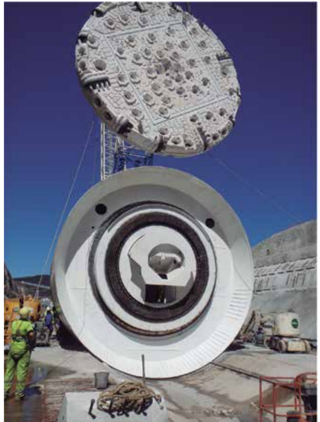
Fig. 3. Rueda de corte con pletinas antiabrasión de 30 mm de espesor en el cono de entrada del escombros
