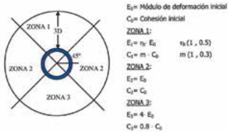
a) Variación de la deformabilidad y de la cohesión alrededor del túnel
