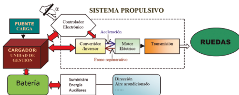
Fig. 2_ Esquema conceptual de la configuración de un vehículo eléctrico. Fuente: López
