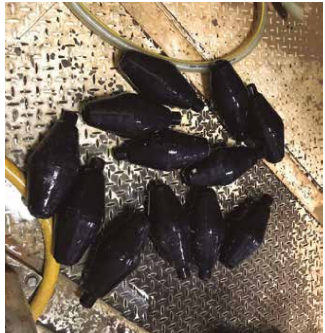
Fig. 3. Biconos en obra a punto de ser instalados
