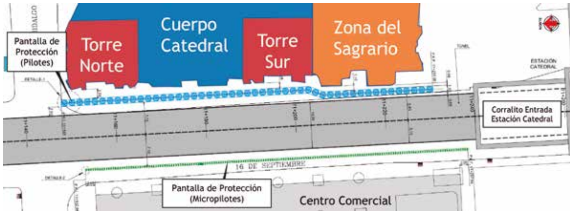
Fig. 3. Planta con las pantallas de protección de la Catedral y el centro comercial
