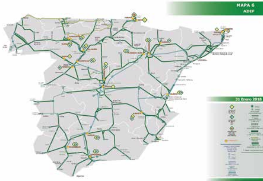
Adif Ancho de vía y cambiadores
