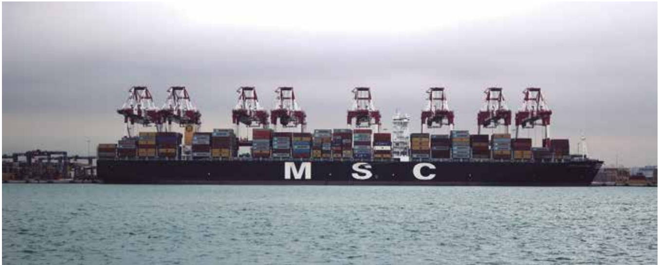
Portacontenedores de MSC operando en la terminal BEST (Huchison Ports) del Port de Barcelona, con un despliegue simultáneo de 8 grúas. FOTO: BEST
