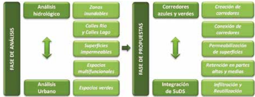
Fig. 2_ Elementos a considerar en el proceso de planificación de 'Ciudades Sensibles al Agua'. Elaboración propia
