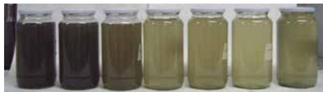
Fig. 3_ Hidrograma y polutogramas medidos en un suceso de lluvia en la cuenca piloto de Fene (N-651; IMD=18.000) en un proyecto de investigación del GEAMA (Universidad de Coruña). Imagen que refleja el aspecto de las diferentes muestras caracterizadas en el mismo suceso (Jiménez 2013, 2014; Suárez, 2016)
