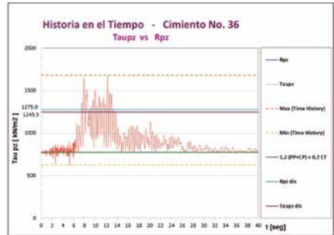
Fig. 8_ Chequeo en el tiempo del estado límite de fallo por punzonamiento del peralto del plato del cimiento interior No. 36
