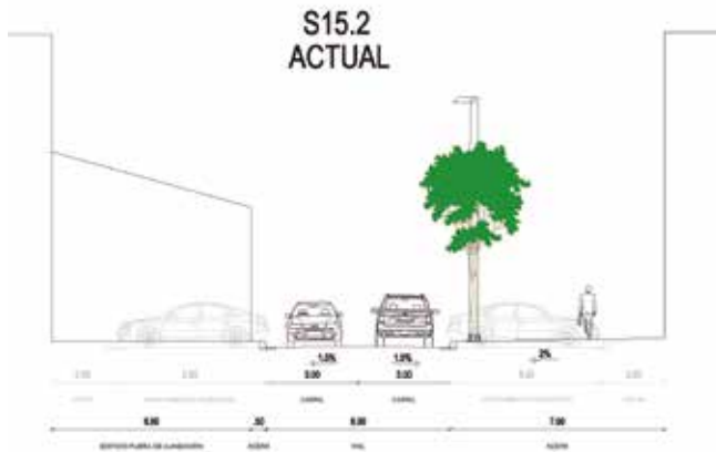
Fig. 7_ Sección del antes tramo 15.2 +
