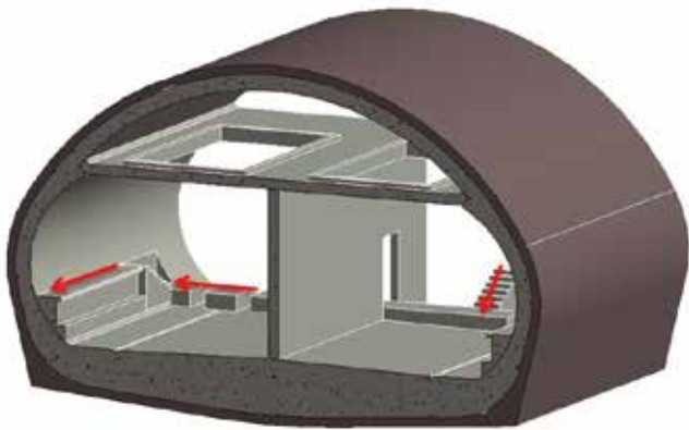
Fig. 4_ Vistas de la caverna en 3D – Modelos con Revit. Vista del lado este (izquierda) y vista desde la estación (derecha)
