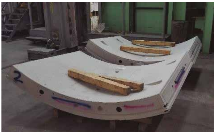
Foto 1_ Dovelas antes de ser sometidas a los ensayos al fuego
