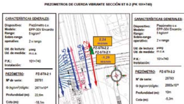
Fig. 3_ Ejemplo del incremento puntual de los piezómetros por el paso de la tuneladora
