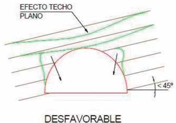
Fig. 11_ Esquema efecto techo plano (Fuente: “Guía sobre control geotécnico en minería subterránea” Laboratorio Oficial J.M. Madariaga LOM. 2015)
