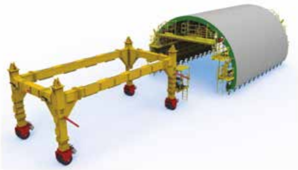
Fig. 7_ Bastidor de traslado con ruedas macizas y cascarón de encofrado
