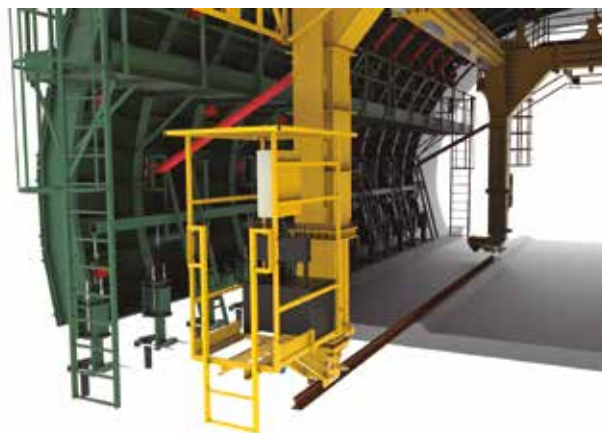
Fig. 1_ Equipo de encofrado para revestimientos de túnel
