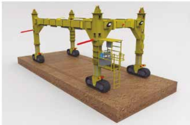
Fig. 8_ Bastidor de traslado con orugas
