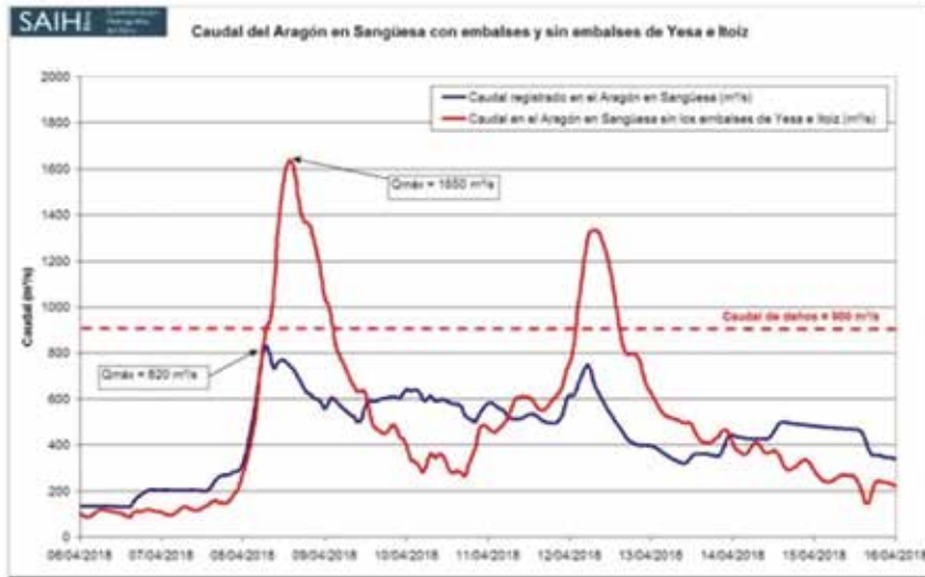
Fig. 3_ Laminación de la avenida del río Aragón a su paso por Sangüesa mediante almacenamiento de agua en los embalses de Yesa e Itoiz
