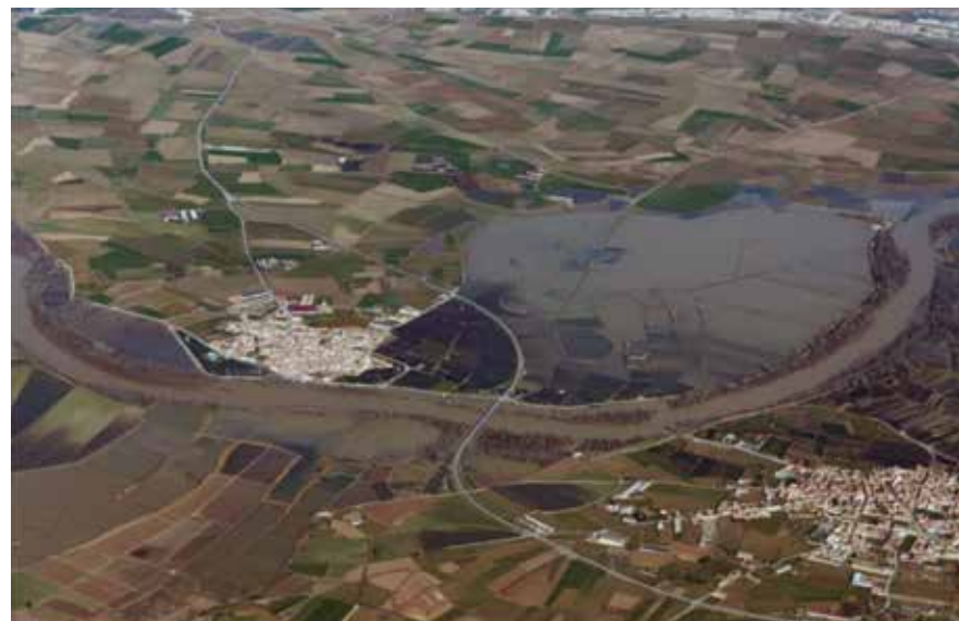
Fig. 4_ Área de inundabilidad temporal controlada de Pradilla de Ebro en el río Ebro en España
