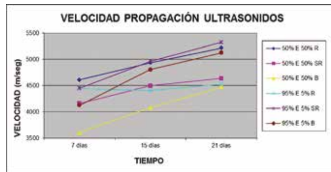
Fig. 2_ Velocidad de propagación de ultrasonidos en los tiempos indicados. Fuente: Autoría propia
