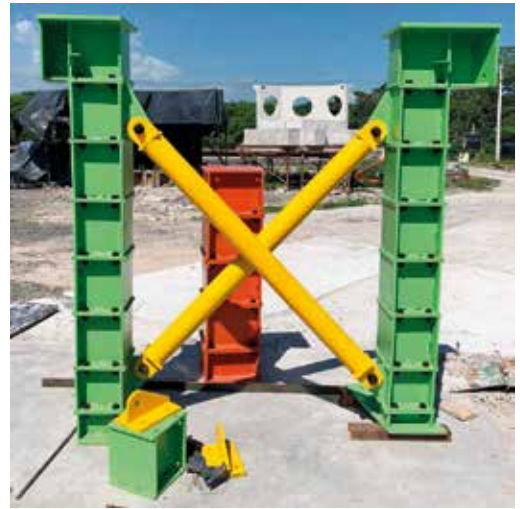
Fig. 3_ Diseño 3D de la estructura de soporte y premontaje de las piezas en taller. Fuente: Civing, S.A. de C.V., extraídos de exposición para el Cliente y Supervisión
