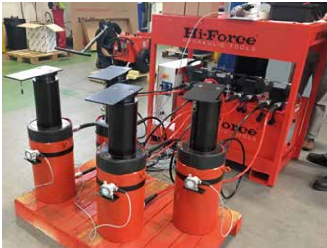
Fig. 4_ Equipo de elevación: gatos con sensores y central hidráulica y pantalla de control durante elevación. Fuente: Hi-Force Limited y Civing, S.A. de C.V. (pantalla durante elevación)
