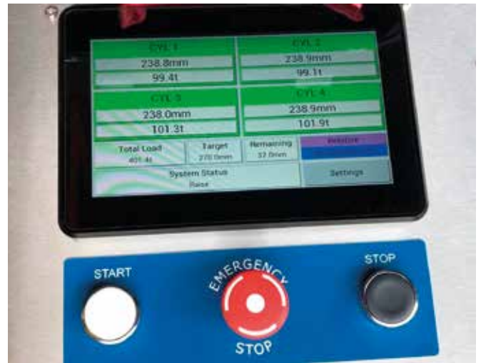
Fig. 4_ Equipo de elevación: gatos con sensores y central hidráulica y pantalla de control durante elevación. Fuente: Hi-Force Limited y Civing, S.A. de C.V. (pantalla durante elevación)
