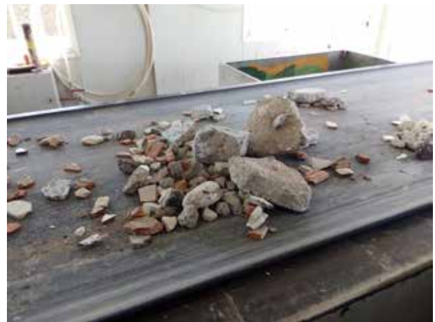
Fig. 6_ Línea de triaje en planta de reciclaje de residuos de construcción y demolición (RCD)
