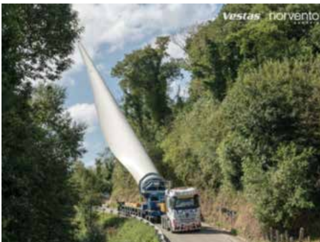
Fig. 12_ Ensanche definido en Road Survey. Fuente ALE HEAVYLIFT, Repotenciación Cabo Vilano, La Coruña
