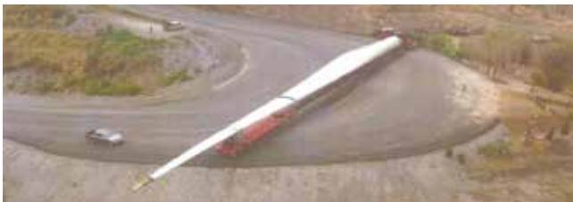
Fig. 12_ Ensanche definido en Road Survey. Fuente ALE HEAVYLIFT, Repotenciación Cabo Vilano, La Coruña
