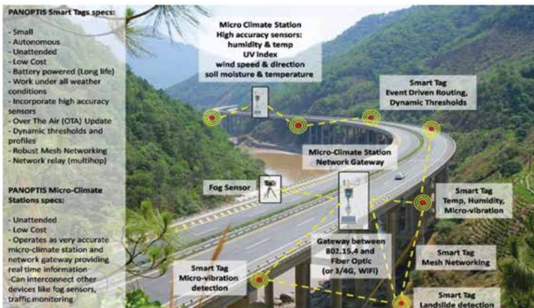
Fig. 4_ Tipología de la red de sensores smart tags y micro-estaciones meteorológicas y componentes conectados en un tramo de carretera según el modelo PANOPTIS
