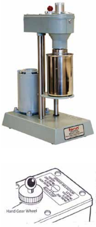
Fig. 8_ Equipamiento para la realización del ensayo (arriba) y detalle del mecanismo de control de la velocidad (abajo)
