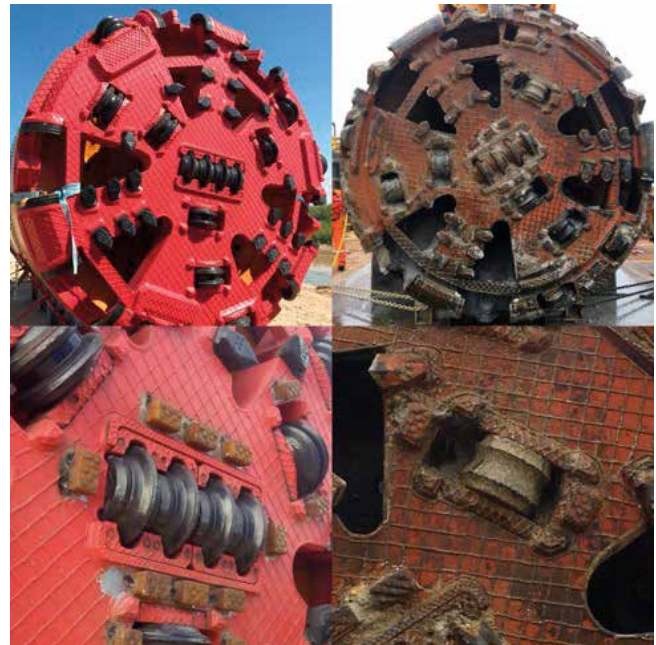
Foto 3_ Antes y después rueda y herramienta de corte
