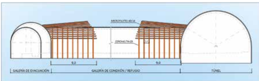
Fig. 9_ Detalle del entronque con galería de conexión
