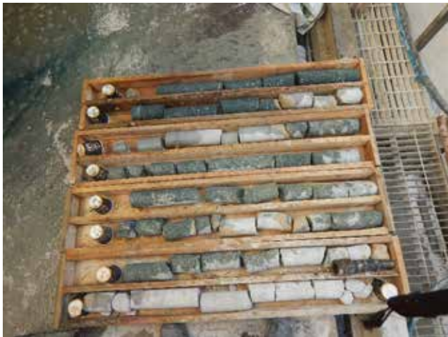
Fig. 3_ Tramos de jet grouting y de arenas inyectadas con ultrafino (más oscuros en la foto)
