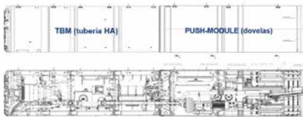
Fig. 6_ Herrenknecht AVN2000D encamisada a D3200 mm y Push-Module
