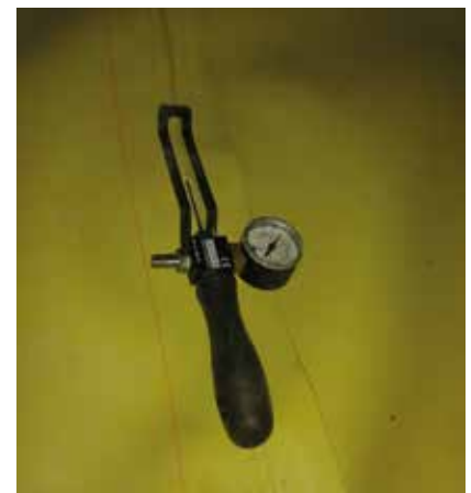
Foto 6_ Prueba de estanqueidad de soldadura
