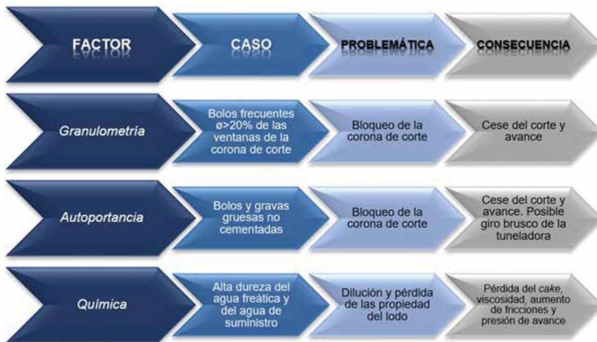
Fig. 3_ Problemática habitual en terrenos con alta presencia de bolos y granulares gruesos no cementados
