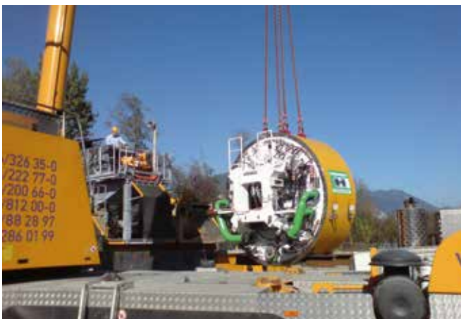
Foto 5_ Tuneladora AVND-4000AB marca HK para los túneles de emergencia de la autopista Berlín-Palermo. Fuente: Herrenknecht (izda.) Foto 6_ Túneles de emergencia durante la ejecución para la autopista Berlín-Palermo. Fuente: Herrenknecht (dcha.)
