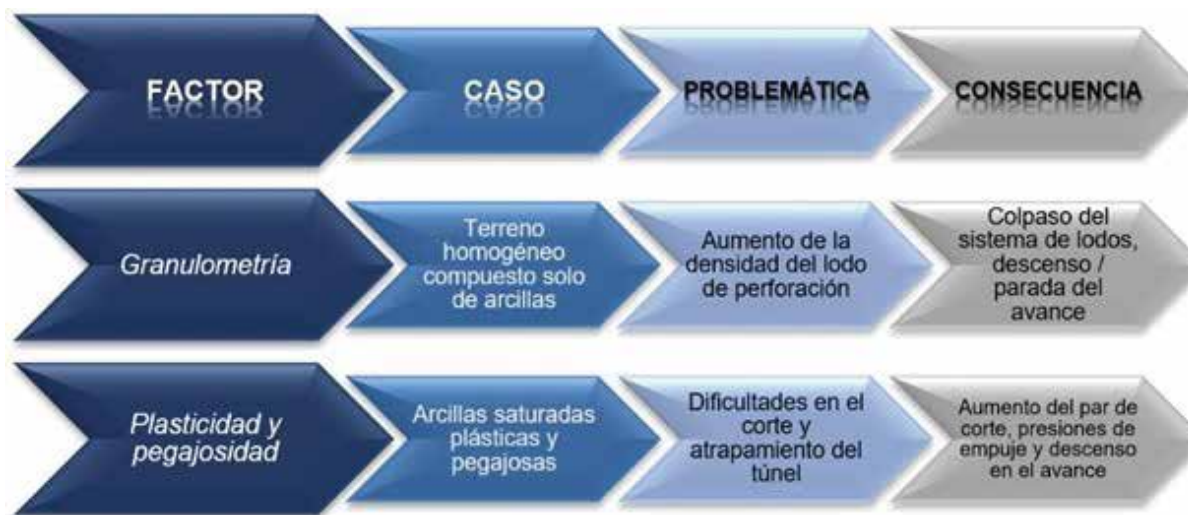
Fig. 4_ Problemática habitual en terrenos arcillosos plásticos y pegajosos
