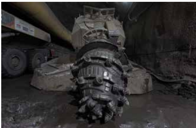
Fig. 5_ Rozadora Mitsui Mike S300 utilizada con cabeza longitudinal
